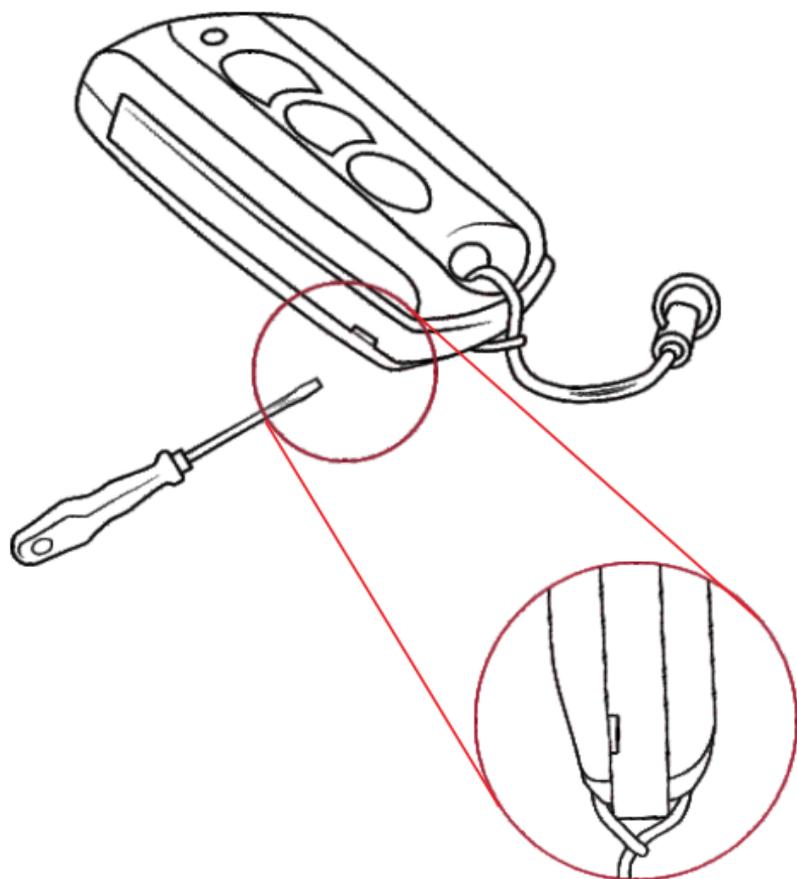
Substitua a bateria observando a polaridade da mesma.
